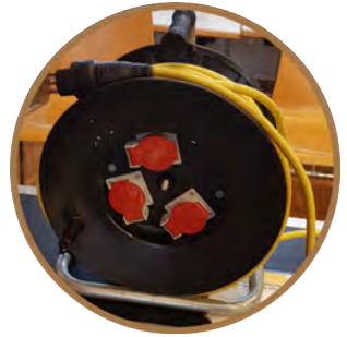
Kabeltrommel (gelbes Kabel 230V)
